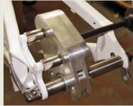
Jeden z nejdražších nástrojů v každé dílně dokáže naprosto přesně zarovnat dosedací plochy pro třmen. To platí jak pro IS uchytí, tak pro Postmount.
