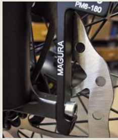
U adaptéru na PM uchycení je důležitá nízká výška hlavy šroubu, který je ukrytý pod třmenem. Jestliže by šroub vychýlval, třmen se o něj opře a nebude možné jej seřadit ani bezpečně upevnit. Navíc může dojít k prasknutí materiálu při dotahování.
