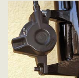
Domácí řešení strženého závitu nabízí šroub vlepový do PM uchytí a skrz jeho odříznutou hlavu nasazený třmen. Ten se pak jednoduše přitáhne maticí.
