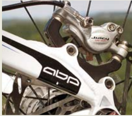
Vyrovnání třmen vůči kotouči ve všech směrech lze díky kloubovým podložkám asi nejjednodušší. Nevýhodou je ale možnost postupného samovolného vychýlení vlivem sednutí materiálů a působení vysoké síly při brzdění. Nutné je tedy tento komplet čas od času zkontrolovat a dotáhnout.
