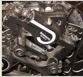
Plastové kroužky s dvojicí zobáčků zamezí přetočení šroubu při povolání. Důležité je pojistky správně umístit, aby nepřišly do kontaktu s kotoučem, na třmen se tak nasazují jen dvě nebo tři, zadní šroub už je totiž příliš blízko kotouče.
