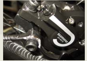
Po dotáhnutí šroubů třmene se většinou odloupe z uchyty lak. Nezábrání tomu ani podložky pod šrouby. Z vnější strany to nicmáno nevadí, ale totéž se vlastně může stát zevnitř, a proto je dobré vnitřní plochu ořezávat.
